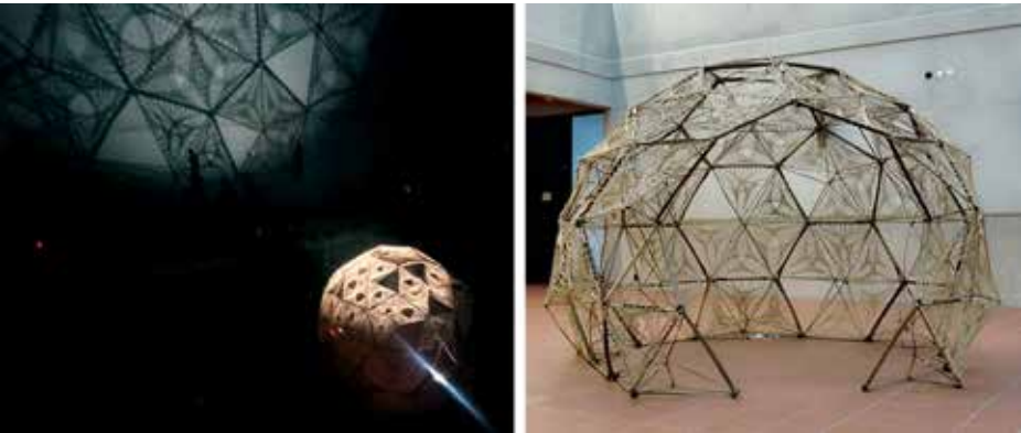
Fotoğraf. 1: Biyokompozit örgü uygulamasıyla geliştirilmiş olan bir jeodezik kubbe. Fotoğrafta görülen strüktür, TU Delft Building Technology yüksek lisans programında yürüttüğüm Technoledge Design Informatics dersi kapsamında öğrencilerle gerçekleştirilen bir atölye çalışmasının sonuç ürünü olarak Nisan 2019'da üretilmiştir.
