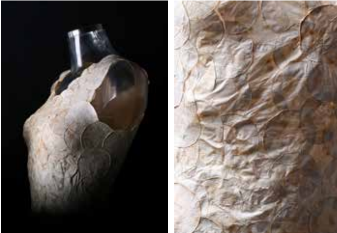
Fotoğraf. 3-4: Mantar miselyumundan yapılmış MycoTEX tekstili.
